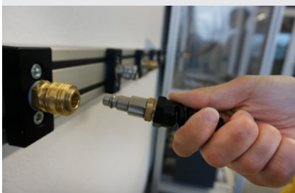
Einhandbedienung: Zur Verbindung einfach den Stecknippel in die Kupplung eindrücken.
