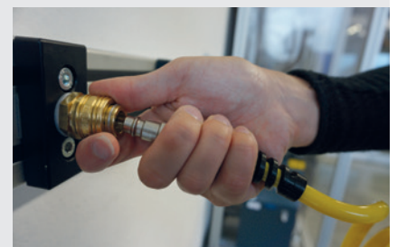
Das Entkuppeln erfolgt durch Zurückschieben der Kupplungshülse (mit automatischem Schließmechanismus bei absperrenden Kupplungen und Stecknippel).
